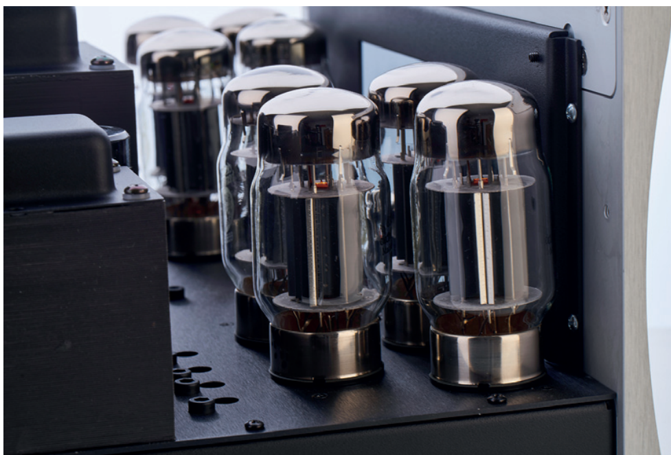
Je vier 6550 sorgen für eine Ausgangsleistung von 150 Watt in Tetroden-Schaltung
