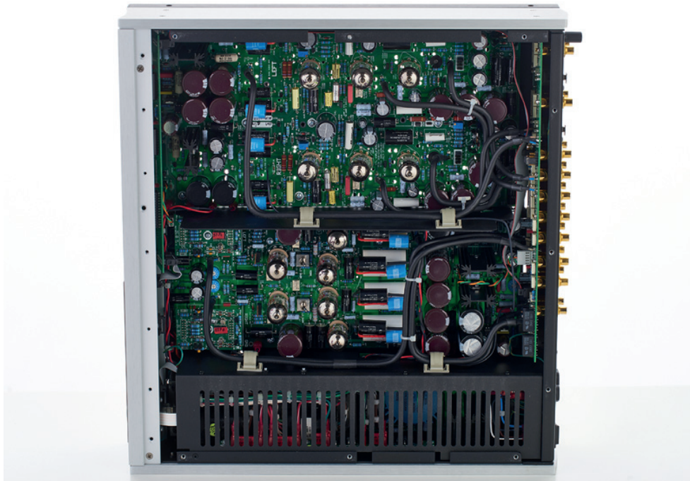
Unten das geschirmte Netzteil, darüber die Vorstufen-Platine und oben das Phonobord. Auf der Platine mit dem roten Chip links in der Mitte findet die Lautstärkeregelung statt
